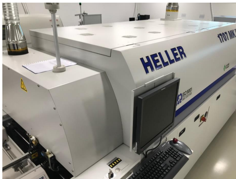
Slika 6.9: Protočna više-zonska peć
