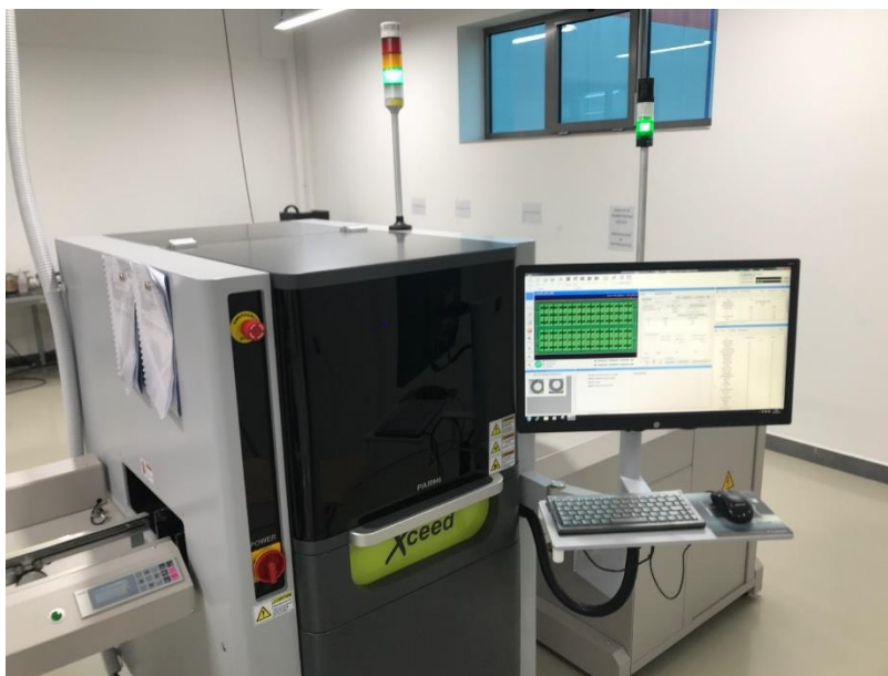
Slika 6.10: Uređaj za optičku kontrolu
