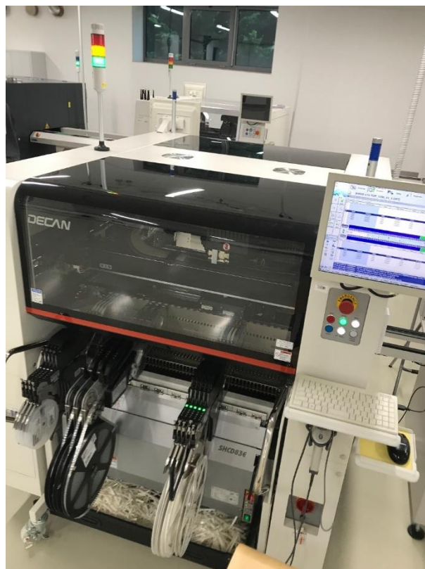
Slika 6.7: Uređaj za automatsko postavljanje komponenata
