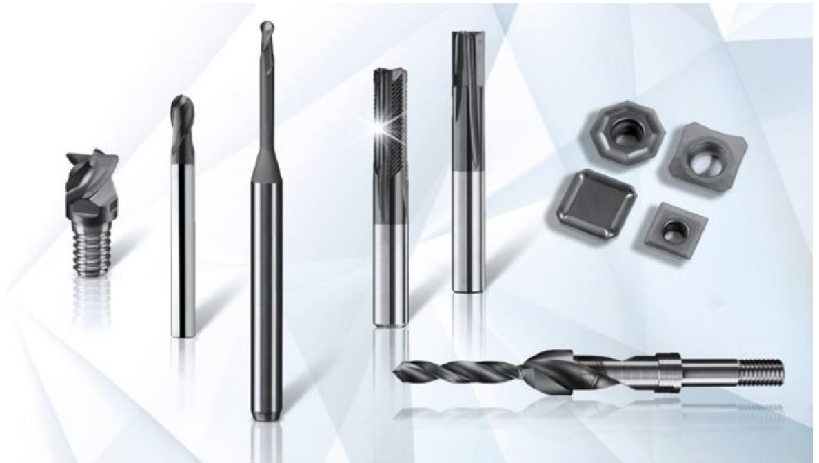
Slika 4.5: Primjeri primjene PACVD dijamantne prevlake [34]
