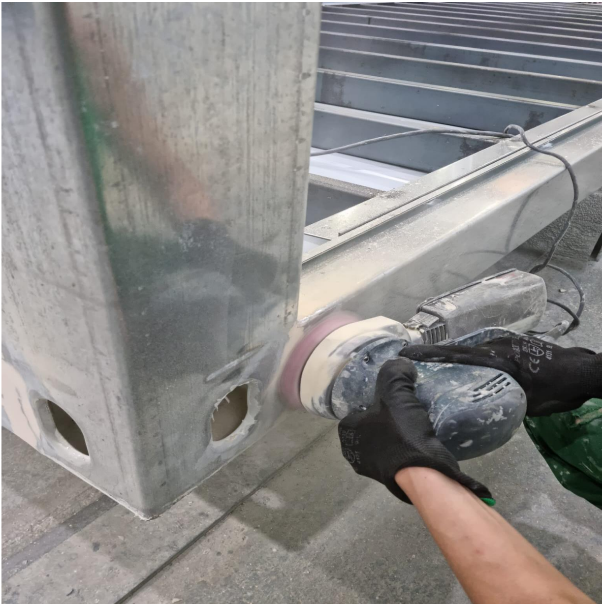
Slika 8.1 Brušenje oštrog rubova zavara
