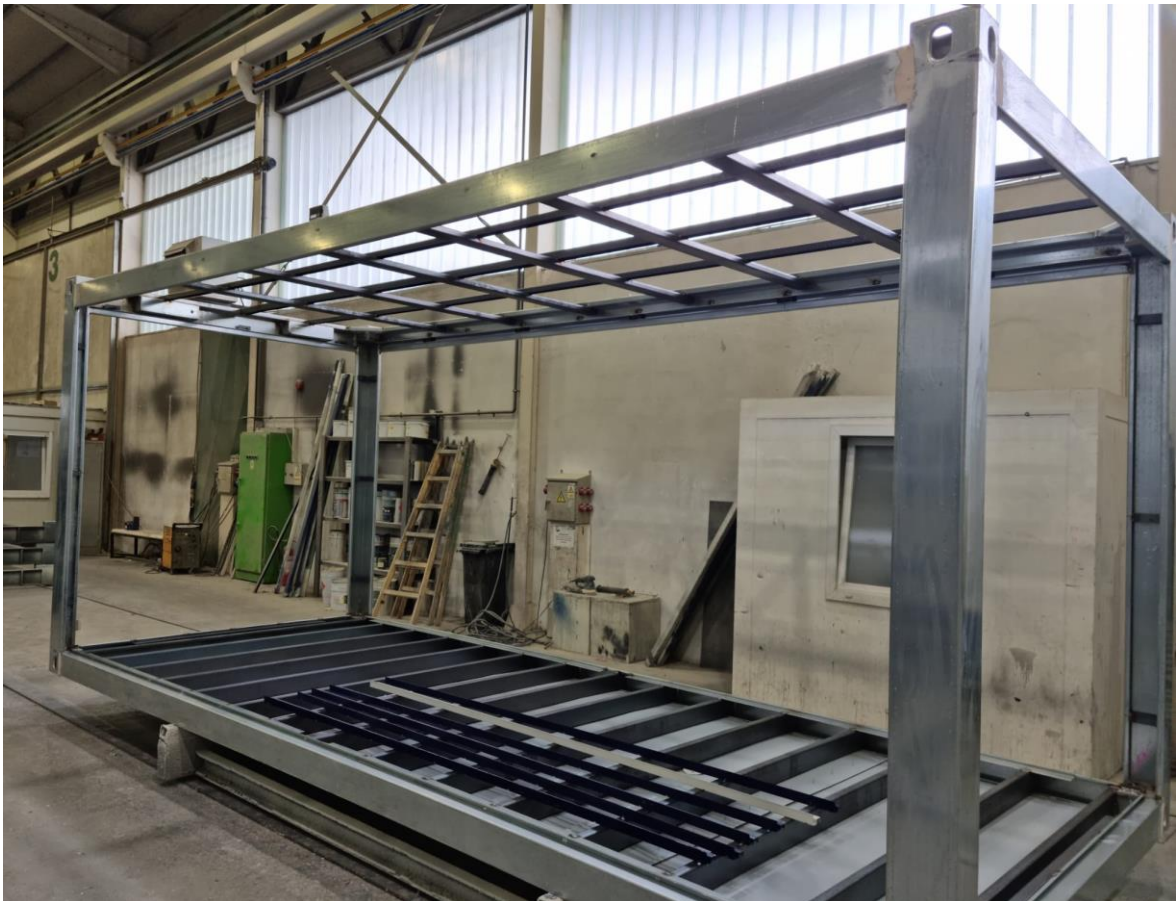
Slika 8.2 Potpuno očišćen kontejner spreman za odlazak u lakirnicu
