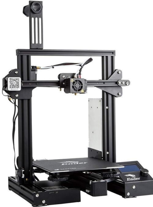
Slika 3.24 Printer Creality Ender 3-Pro
