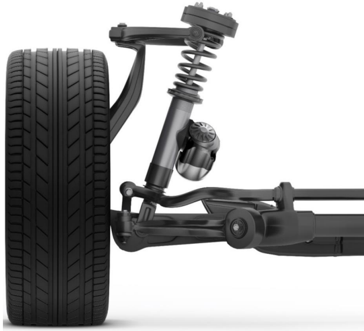
Slika 9.2: Prikaz Clearmotion Proactive ovjesa [17]
