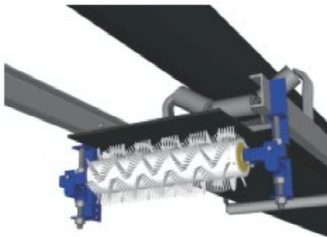
Slika 3.11: Uređaj za čišćenje s četkom [2]
