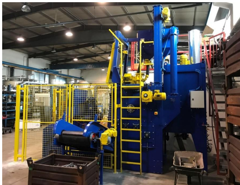
Slika 4.8: Ugrađeni transporter pokraj uređaja za sačmarenje
