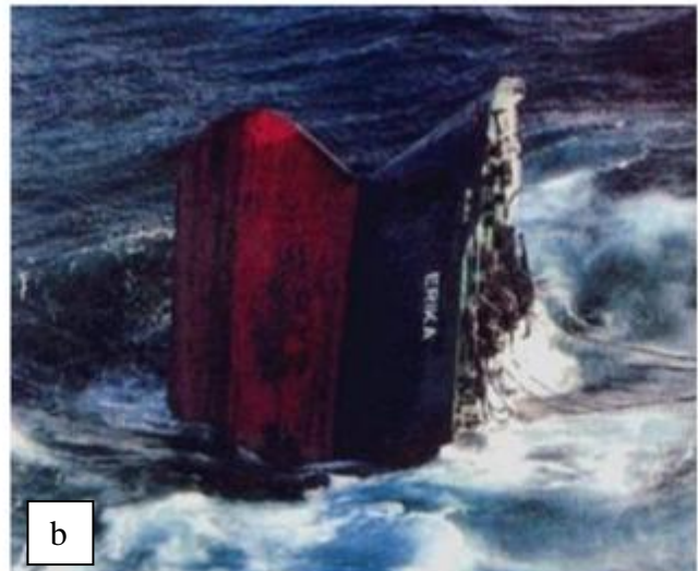
Slika 5.3: a) Primjer korozije ukopanog temeljnog dijela rasvjetnog stupa, b) Primjer posljedice korozije odnosno brodolom tankera Erika [6]
