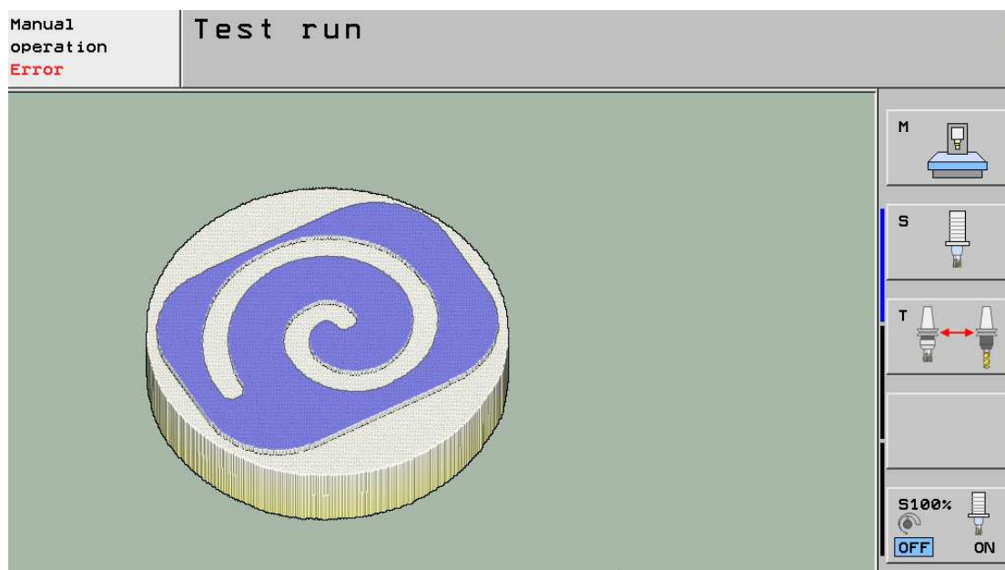
Slika 33. Testni mod za provjeru napisanog programa za izradu spirale [15]
