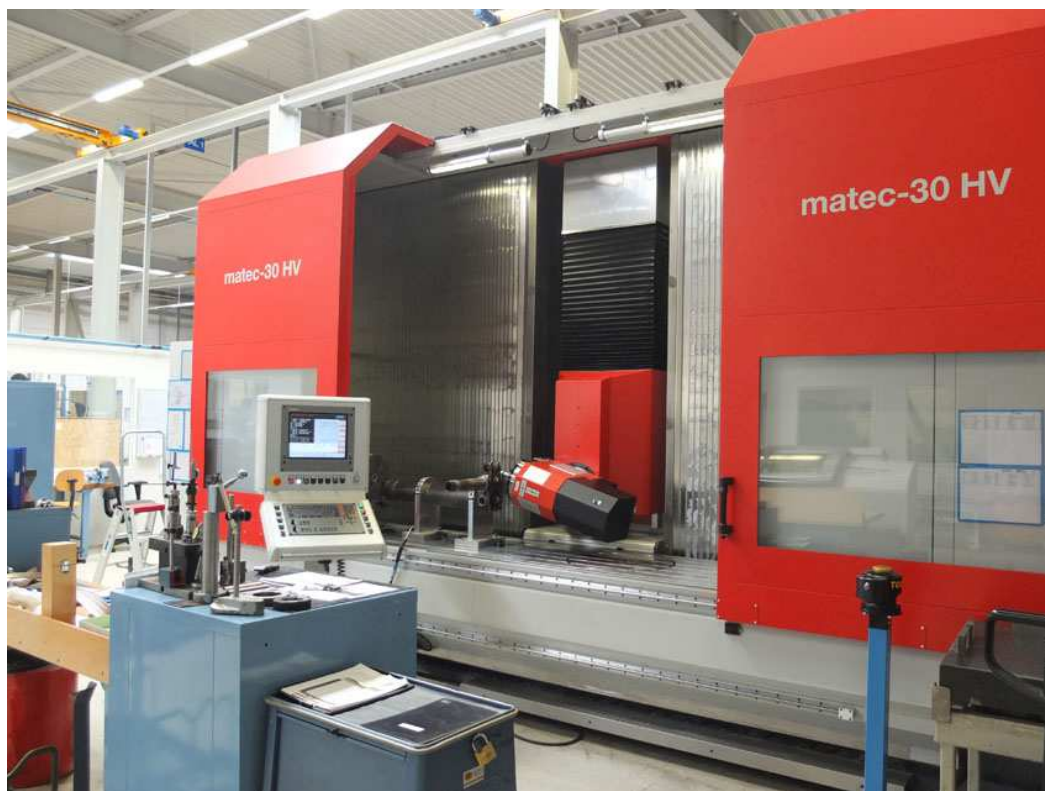
Slika 5. Obradni centar Matec – 30 HV sa zakretnom glavom [7]
