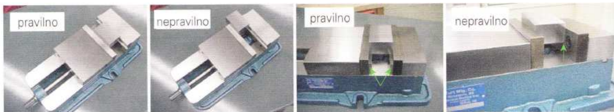
Slika 15. Pravilno i nepravilno stezanje obradka u škripac [5]
