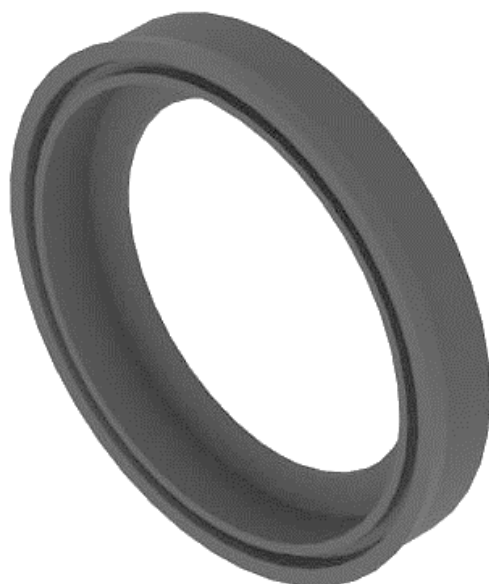
Slika 6.80. Renderirani (foto realističan) prikaz 3D modela manžete ( SolidEdge ST8 - Synchronous Technology )
