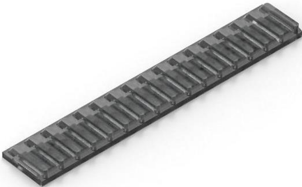
Slika 6.72. Renderirani (foto realističan) 3D transparent model krilca s umetkom (eng. Key Shot ) u programskom alatu SolidEdge ST8 – Synchronous Technology
