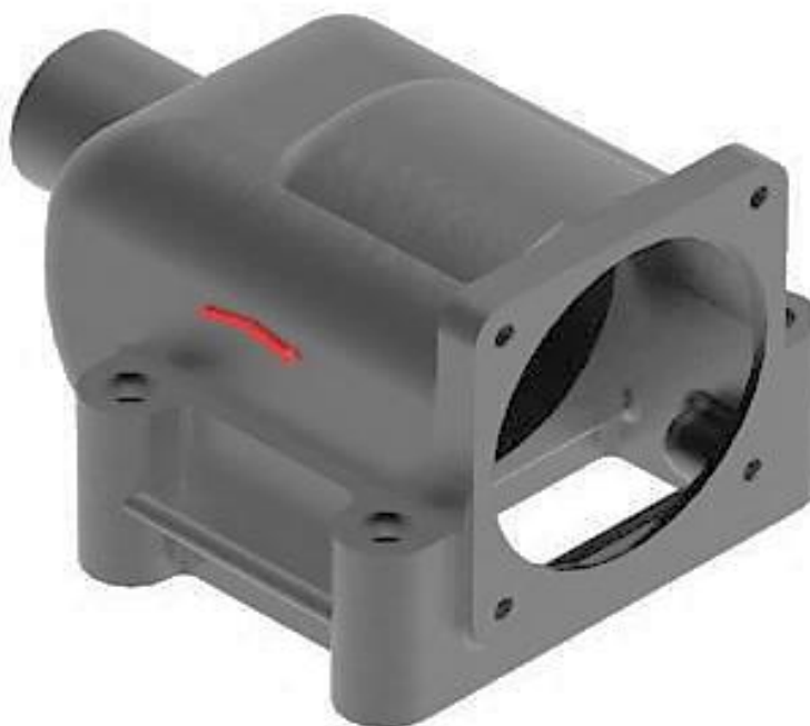
Slika 6.54. Foto realističan prikaz 3D modela kućišta ventila (eng. Key Shot ) u programskom alatu SolidEdge ST8 – Synchronous Technology
