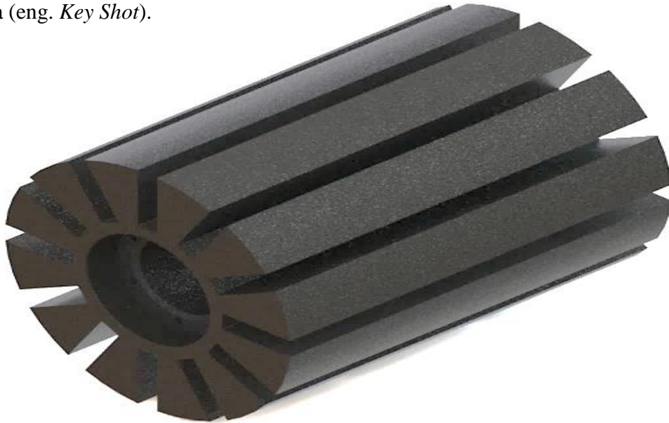
Slika 6.61. Foto realistični 3D model rotora krilne pumpe (eng. Final Render ) u programskom alatu SolidWorks – Ordered Technology
