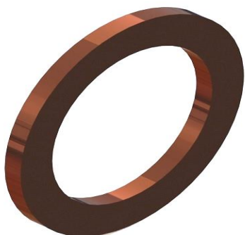
Slika 6.121. Renderirani (foto realističan) prikaz 3D modela zaptivač-a ( SolidWorks - Ordered Technology )
