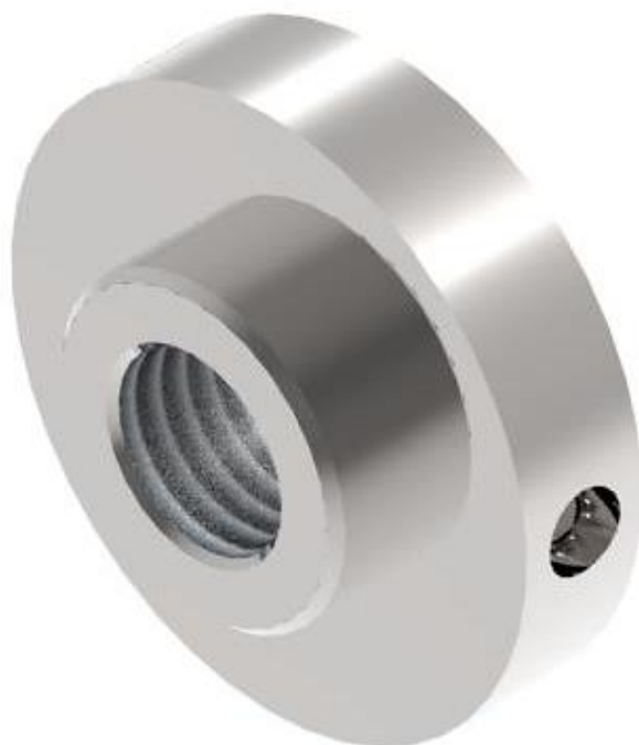
Slika 6.90. Renderirani (foto realističan) prikaz 3D modela matice ( SolidEdge ST8 - Synchronous Technology )
