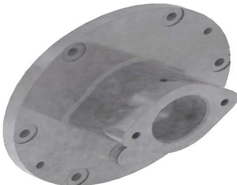
Slika 6.104. Renderirani (foto realističan) prikaz 3D modela prednjeg poklopca ( SolidEdge ST8 - Synchronous Technology )
