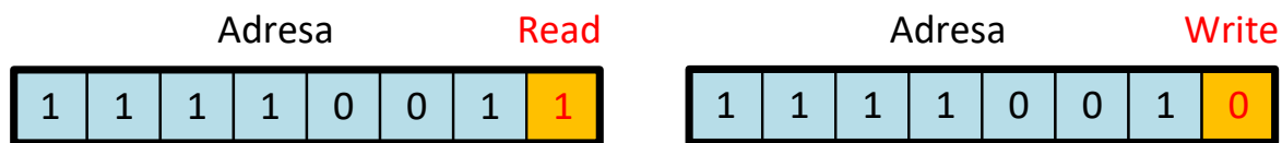
Slika 14.3: Prikaz I2C adrese za čitanje sa Slave uređaja i pisanje na Slave uređaj
