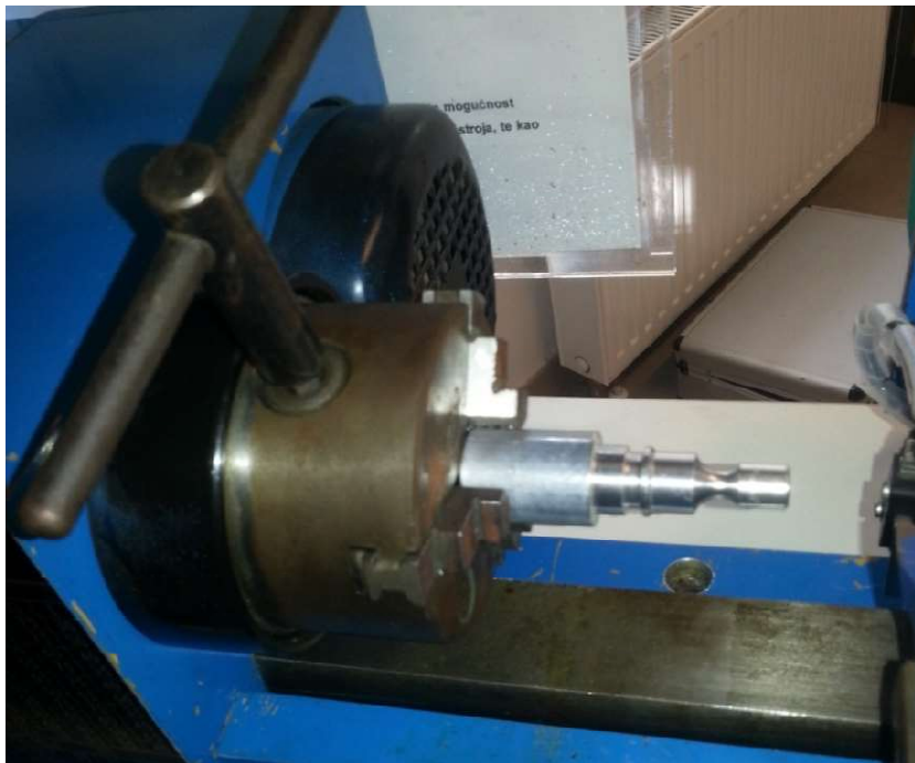
Slika 4.3 Stezanje predmeta obrade na Steznu glavu
