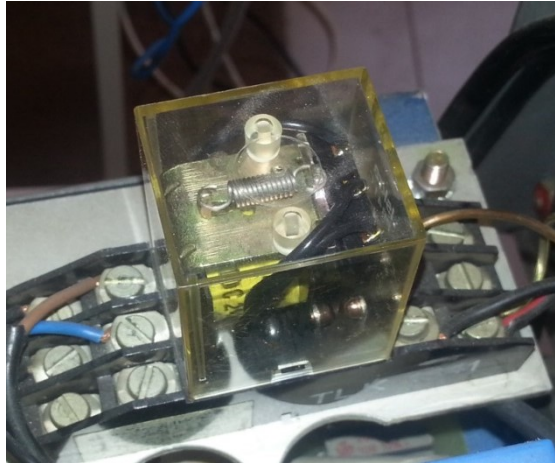
Slika 2.29 i Relej Iskra PR41C 220V 50Hz
