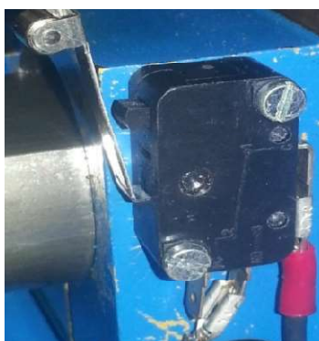
Slika 2.32 Mikroprekidač na CNC tokarilici HobbyMat MD65
