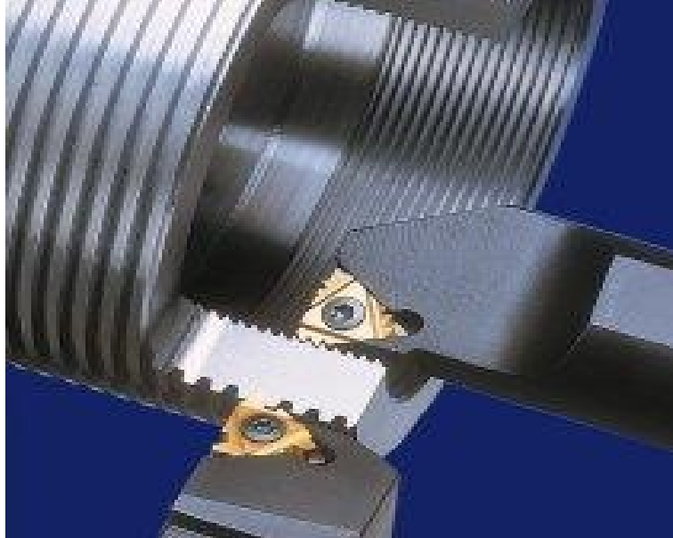
Slika 2.5 Tokarenje vanjskog i unutarnjeg navoja [7]
