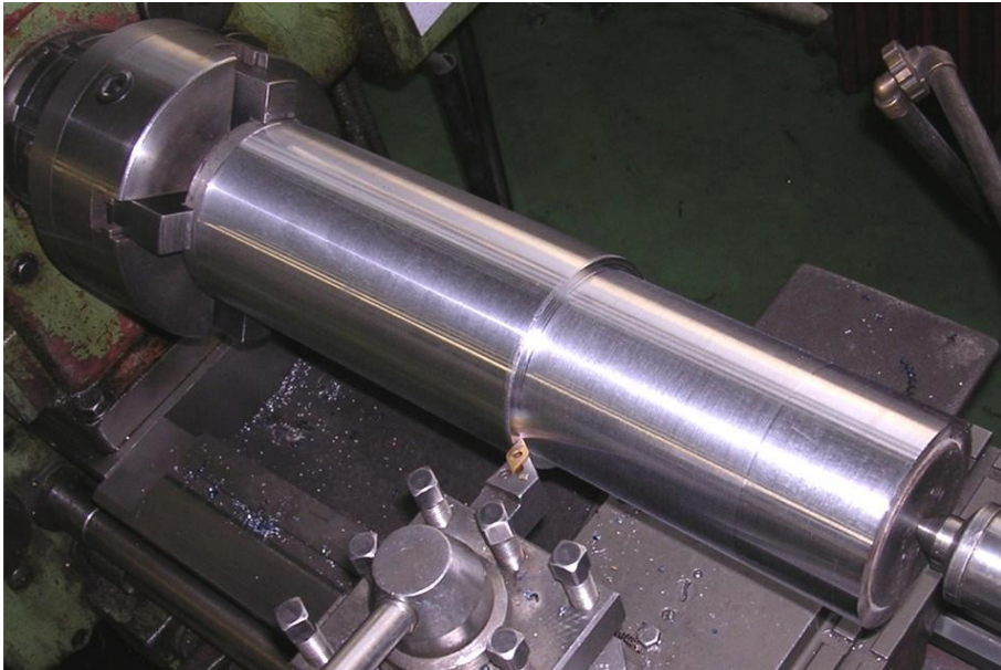
Slika 2.3 Uzdužno vanjsko tokarenje [7]
