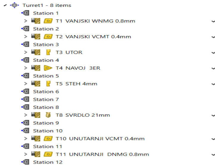
Slika 6.13 Prikaz korištenih alata za izradu
