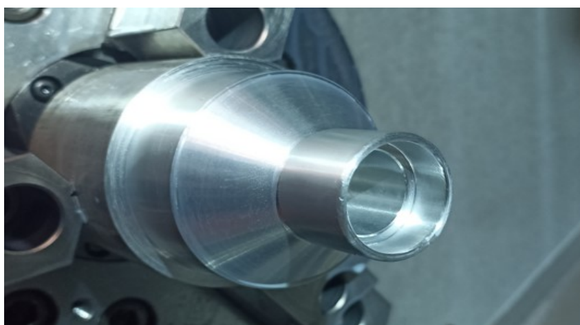
Slika 6.66 Operacija rupa grubo – realna obrada
