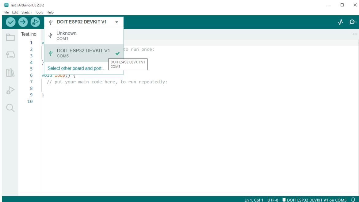
Slika 2.3: Prikaz padajućeg izbornika za odabir mikrokontrolera
