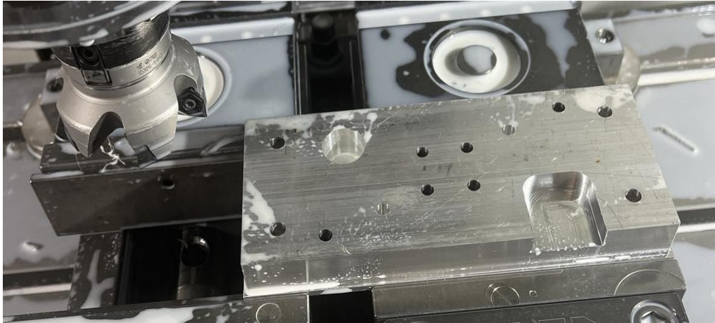
Slika 9.6: Operacija obrade površine planskim glodalom
