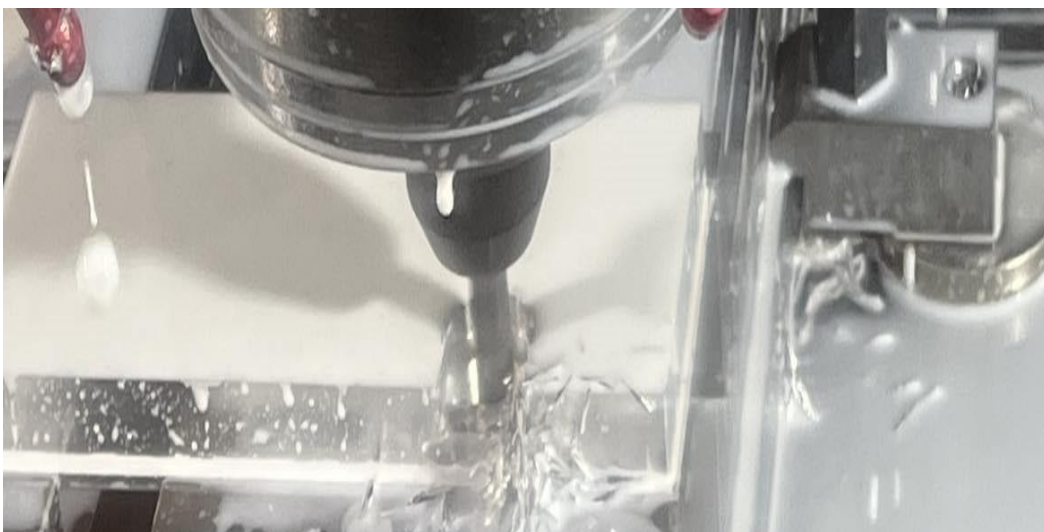
Slika 9.2: Gruba obrada vanjske konture i džepa sa glodalom promjera 10 mm
